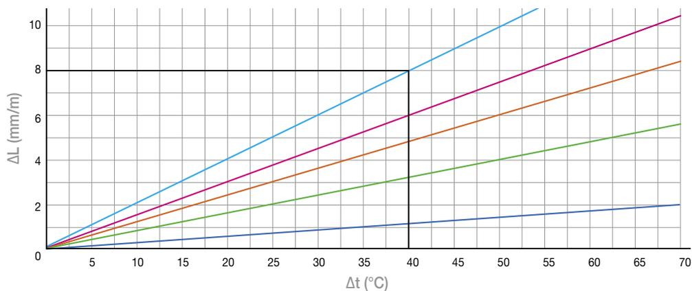
**Esempio:** Tubazione PE – sbalzo termico  $\Delta t$  40  $^{\circ}\text{C}$  – allungamento 8mm – Per 5 mt di tubazione (8x5) 40 mm.
